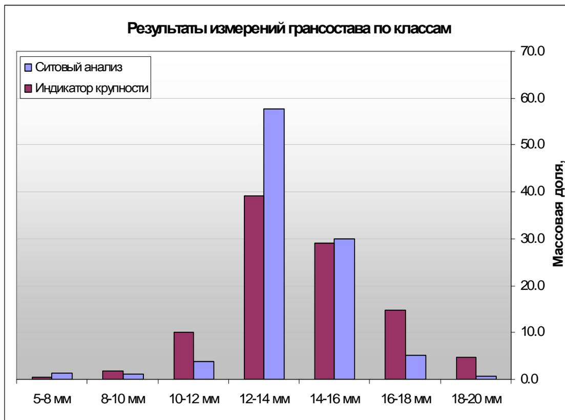
**Рис. 2.** Результаты тестового определения гранулометрического состава окатышей
