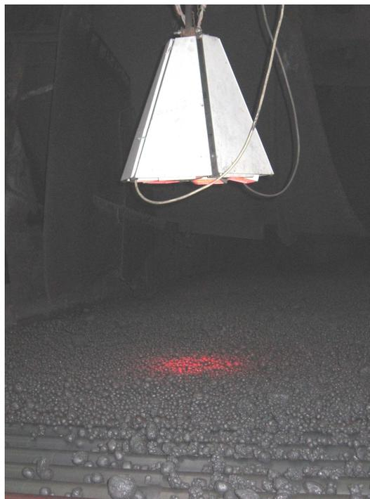
**Рис. 1.** Расположение УСВ над роликовым грохотом линии №8 обжиговой машины №2 Костомукшского ГОКа
