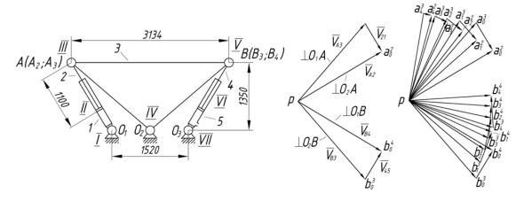
но отличаются от движения штока 4. Из этого следует, что связывать гидравлической связью полости гидроцилиндров 1 и 5 нельзя, или эта связь должна быть особым образом согласованна. В противном случае система окажется неработоспособной.
