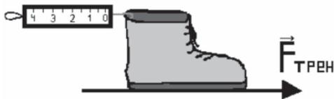
Рис. 1. Измерение силы трения
