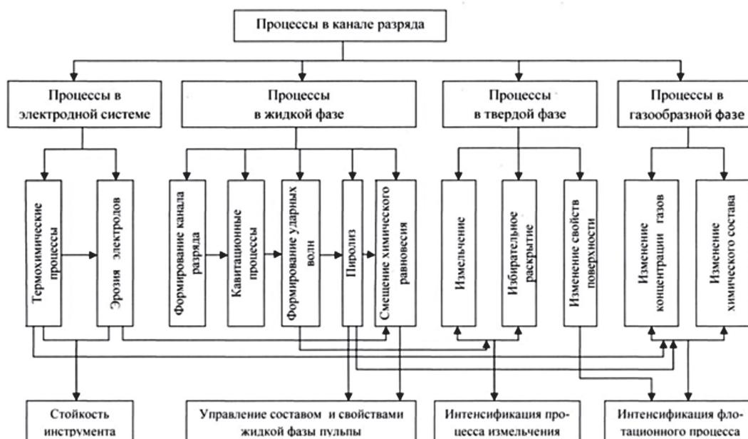
Рис. 2. Схема взаимосвязей основных физических процессов разрядноимпульсной обработки в обогащении и их влияние на выходные показатели
