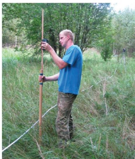
Рис. 1. Проведение замеров микропрофиля на участке дороги типа «заросшее поле»
