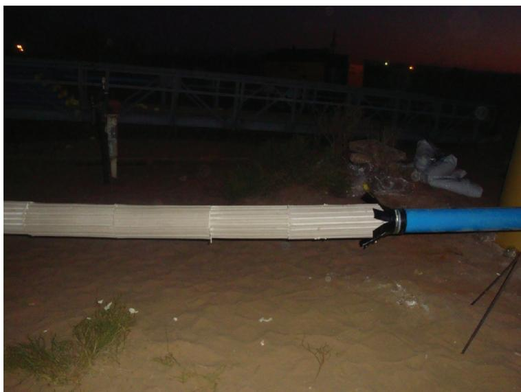
*Рис. 2. Вид нижнего пакера и набора гильз в собранном состоянии*
