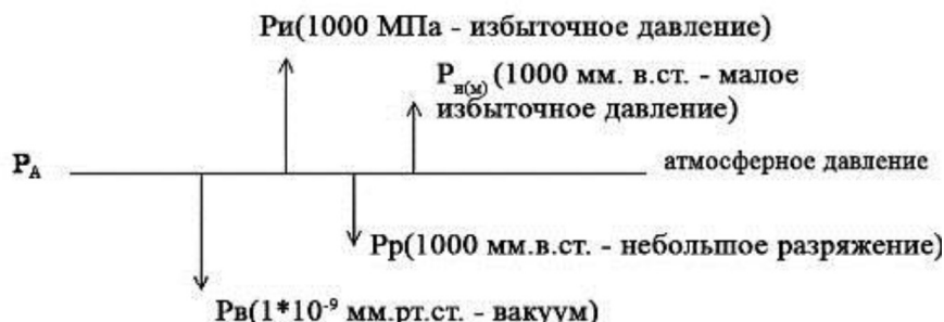
Рис. 1. Диапазоны измерения давлений в промышленных условиях
