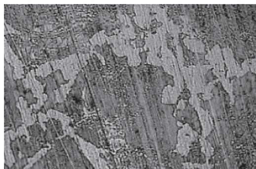
Рис. 2. Микроструктура образца трубы российского производства (увеличение X 1000)
