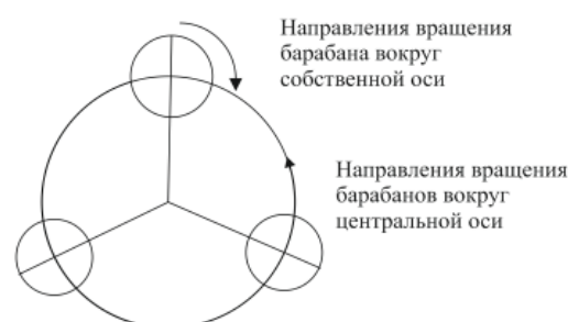
Рис. 1. Принцип действия планетарной мельницы
