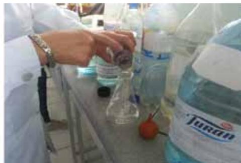
*Рис. 1. Определение жёсткости воды*
