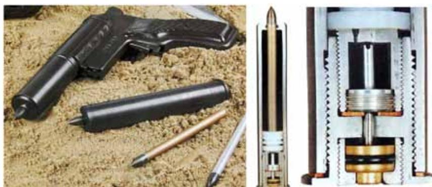
Рис. 2. Слева пистолет SSU, в центре патрон в разрезе, справа конструкция капсулы и камеры высокого давления
