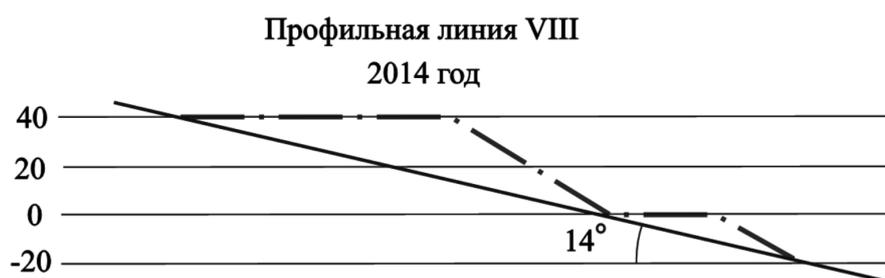
Рис. 2. Проектный профиль уступа внутреннего отвала (гор. 0)
