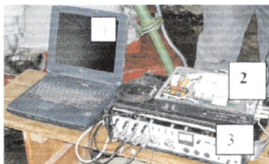
Рис. 5. Аппаратура для оцифровки и обработки сигналов на ЭВМ: 1 – ЭВМ; 2 – АЦП (аналого-цифровой преобразователь); 3 – виброанализатор
