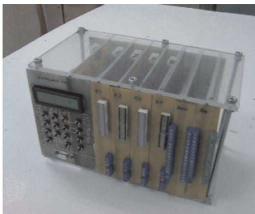
Рис. 1. Многопроцессорный программируемый контроллер «Интеграл-4АС»
