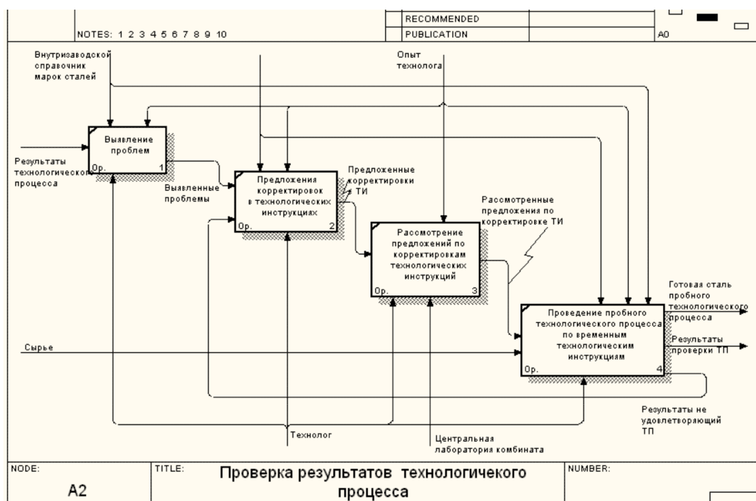
Рис. 3. Декомпозиция диаграммы A2 «Проверка результатов технологического процесса»
