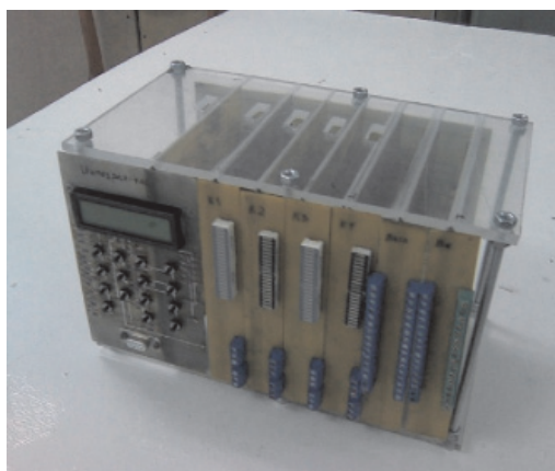
Рис. 1. Многопроцессорный программируемый контроллер «Интеграл-4АС»
