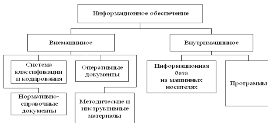
Рис. 1. Структура информационного обеспечения АСУ
