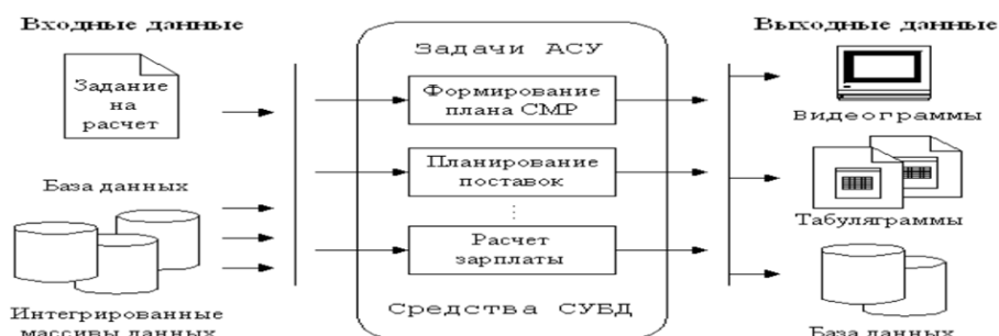
Рис. 3. Схема обработки массивов базы данных в задачах АСУ
