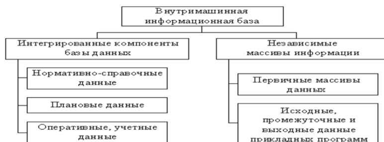
Рис. 2. Состав внутримашинной информационной базы
