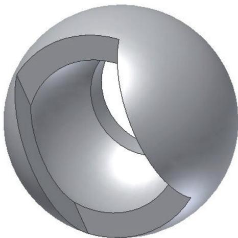
Рис. 2. Электронная геометрическая модель полого шара со сквозными отверстиями
