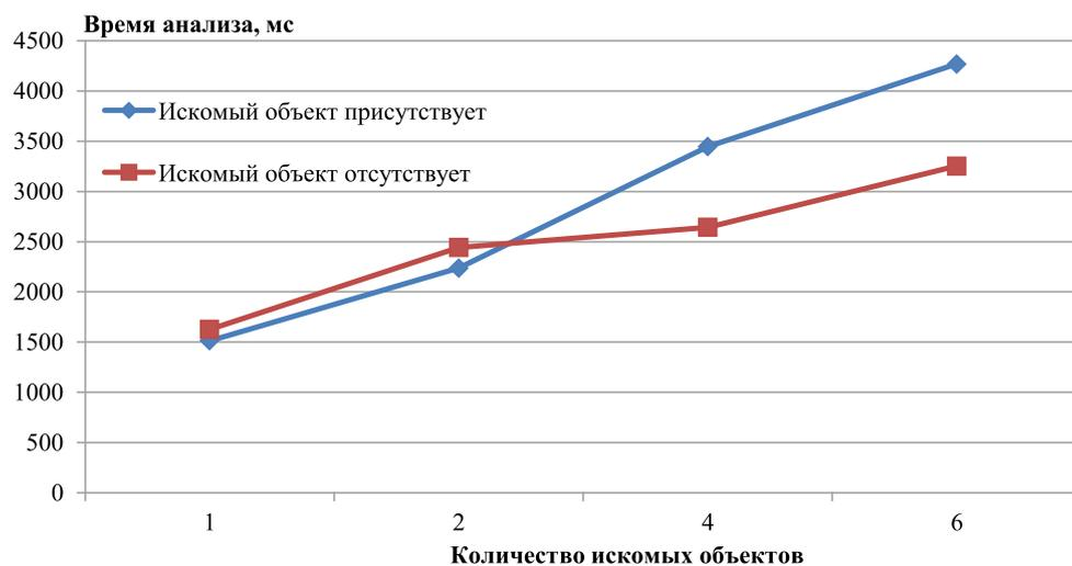
Рис. 2. График зависимости общего времени анализа изображения от количества искомых объектов
