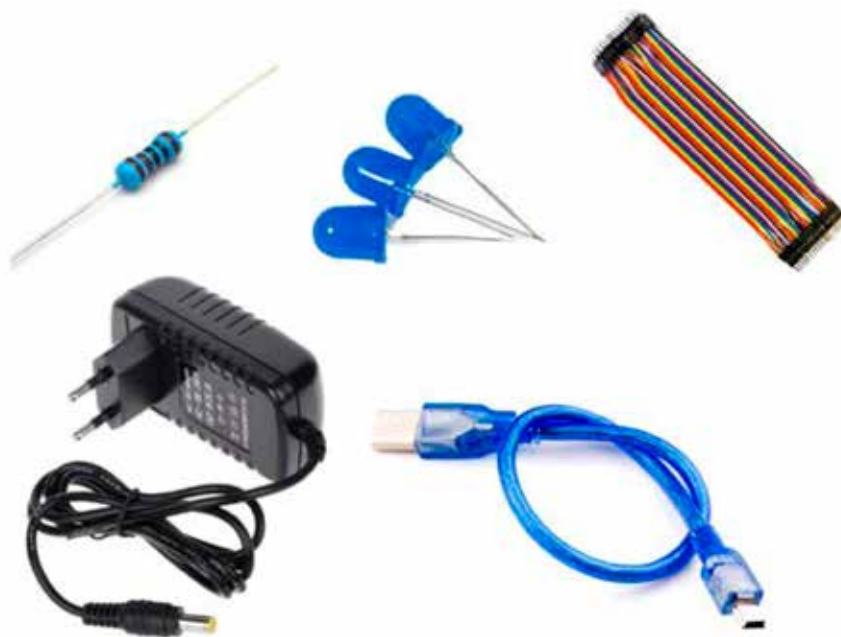
Рис. 1. Элементы для создания схемы (резистор, светодиоды, провода типа папа-папа, блок питания, USB кабель)
